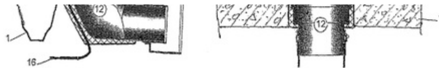
Рис. 1.11. Воронка внутреннего водостока кровли с травяным растительным покровом (а) и инверсионной кровли (б)
