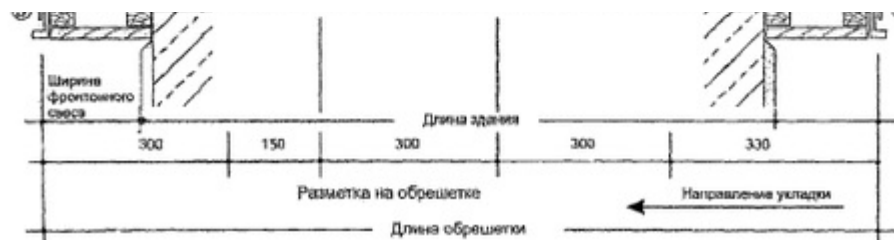
Рис. 1.16. Схема для расчёта длины кровли с боковой цементно-песчаной (а) и облегчённой (б) черепицей
