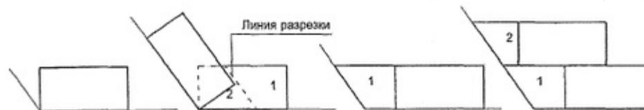
Рис. 2.3. Разрезка и укладка теплоизоляционных плит в тупых узлах кровли
